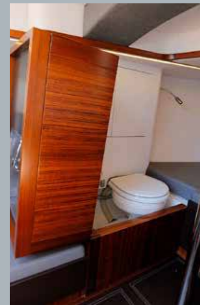
Onder het wegklapbare keukenblok is het toilet geplaatst.
